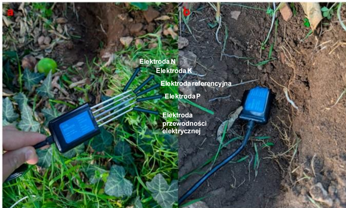
Elektrody czujnika NPK (a) i czujnik zainstalowany w glebie (b) [Bulacio Fischer i in. 2025] Rysunek zawarty w cytowanej pracy wykorzystano na podstawie licencji Creative Commons (CC BY) ( https://creativecommons.org/licenses/by/4.0/ ).
