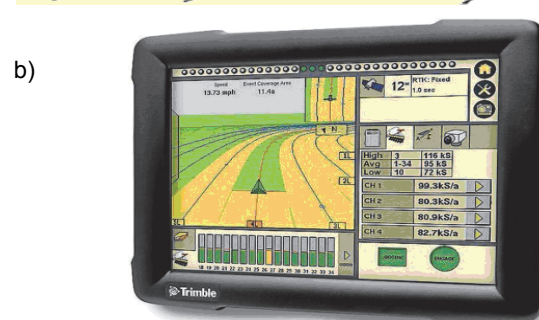
Schemat stosowania systemu GPS do prowadzenia na polu sprzętu do rozsiewania nawozów; źródło: a) JTI, b) Agri Con GmbH
