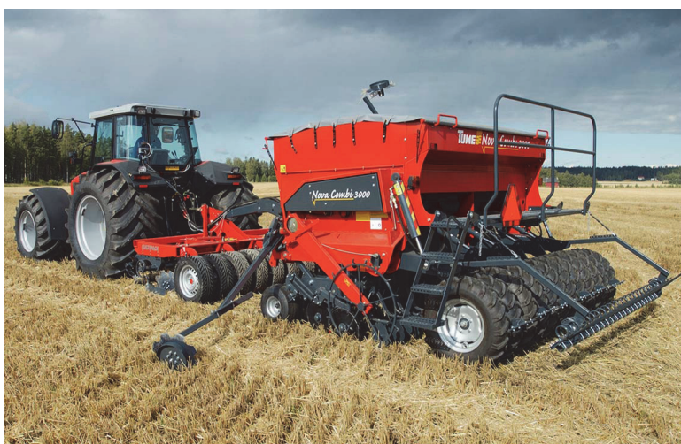
Aggregat do jednoczesnego wysiewu nasion i nawozów; źródło: NILSSON, NILSSON [2005]
