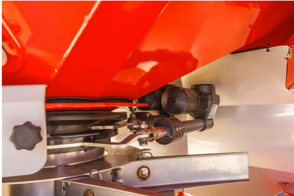
Siłownik elektryczny otwarcia zasuwy w rozsiewaczu Kverneland Exacta TL GEOspread, (fot. Kverneland).
