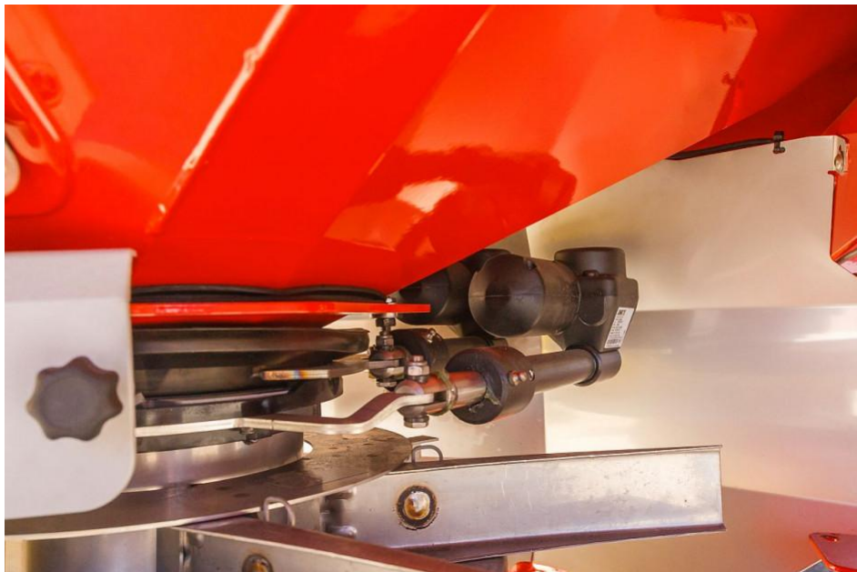
Siłownik elektryczny otwarcia zasuw w rozsiewaczu Kverneland Exacta TL GEOSpread, (fot. Kverneland).
