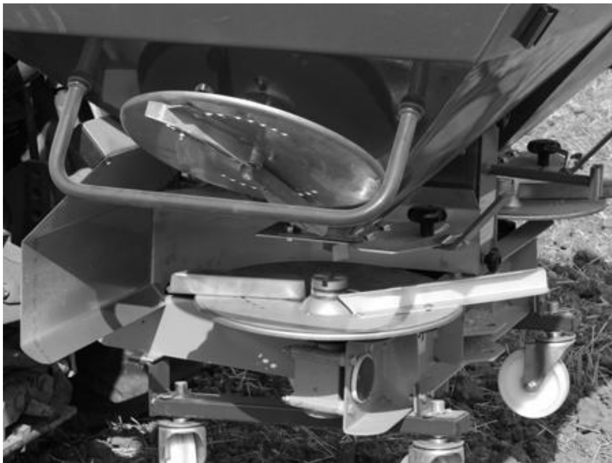
Tarcza do wysiewu granicznego przymocowana do zbiornika nawozowego rozsiewacza MXpremium 1200, (fot. ITP-PIB)
