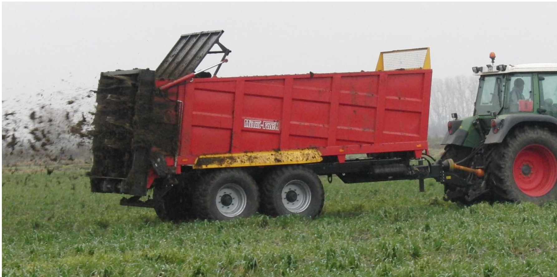
Widok podczas eksploatacji rozrzutnika obornika o ładowności 14 ton, wyposażonego w adapter pionowy 2-walcowy z dużymi talerzami (fot. ITP-PIB)
