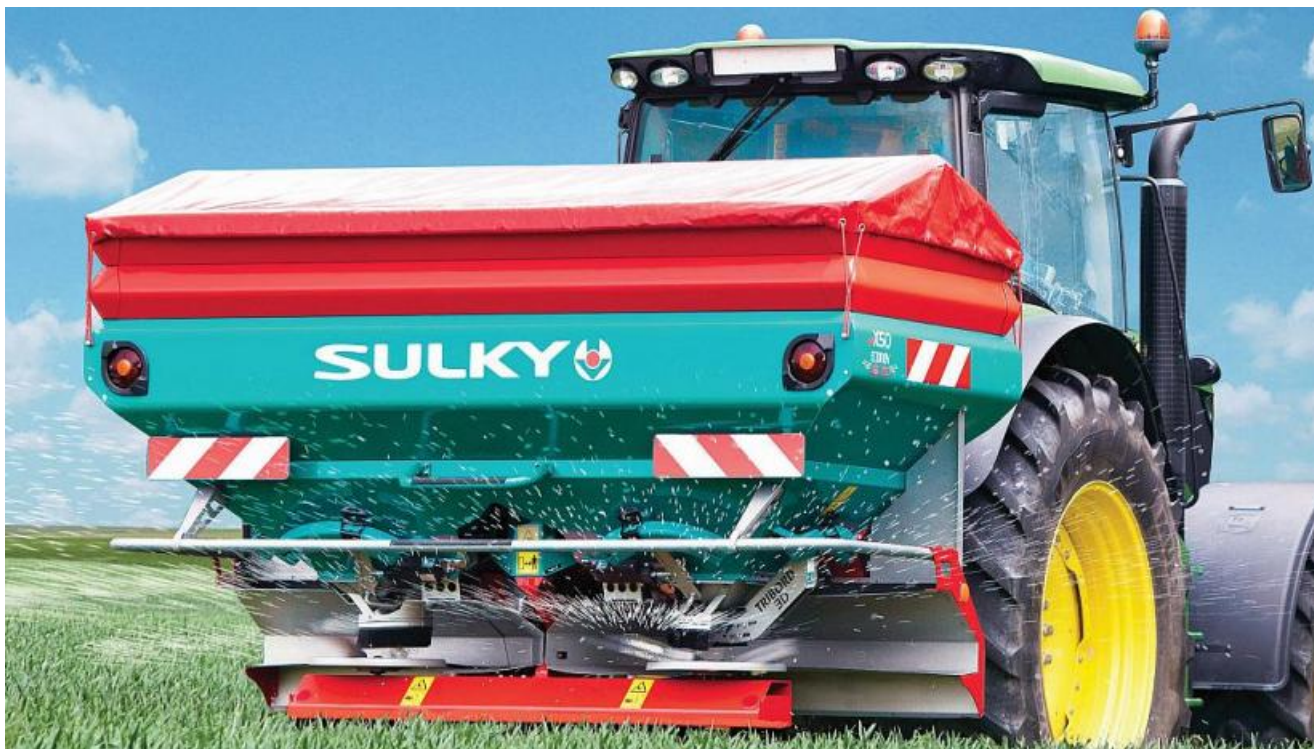
Rozsiewacz Sulky X50-Econov z automatycznym dopasowaniem szerokości roboczej i dawki nawozu za pomocą systemu Econov, (fot. Sulky)
